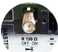
**IMPORTANT !** Dans un bus RS485, la résistance de terminaison du premier et du dernier appareil doit être active.
