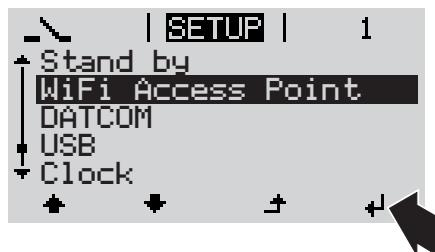
L'onduleur établit le point d'accès WiFi. Le point d'accès WiFi reste ouvert pendant 1 heure. Le commutateur IP sur le Fronius Datamanager 2.0 peut rester en position de commutation B avec l'activation du point d'accès WiFi.
